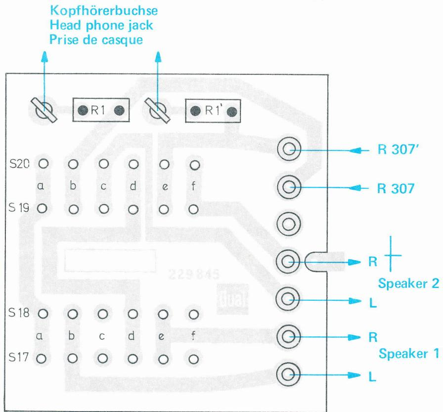
Fig. 13 Pegelreglerplatte 232 455 (Leiterseite)
