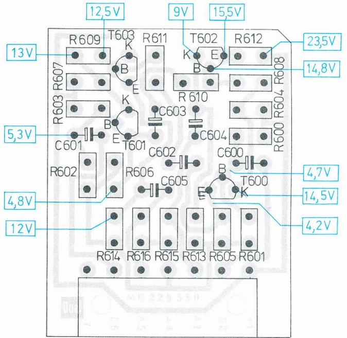
Fig. 22 IC-Verstärker V
