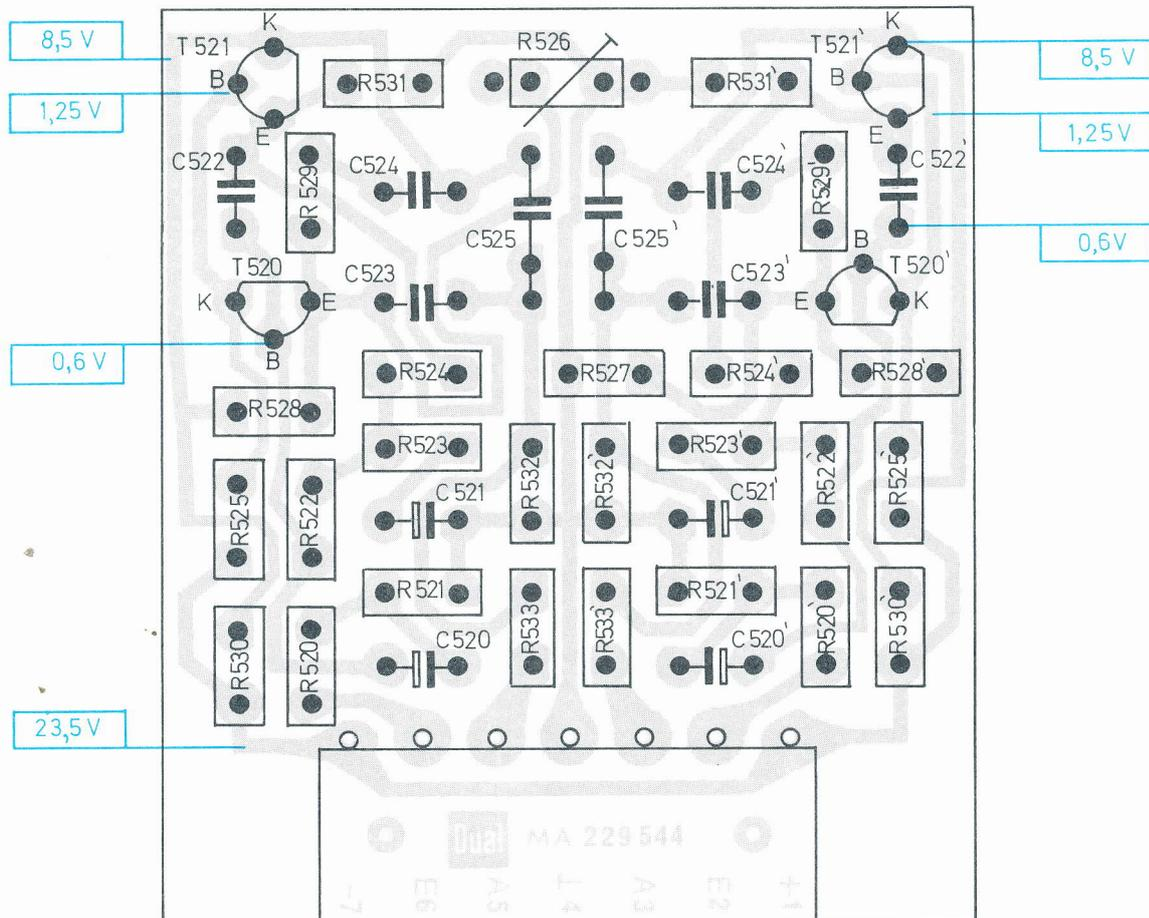
Fig. 16 Eingangs-Impedanzwandler II Schaltbild
