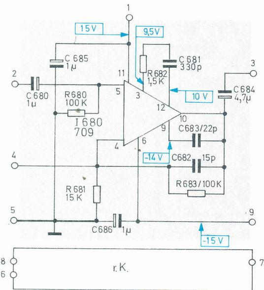
Fig. 23 IC-Verstärker V
