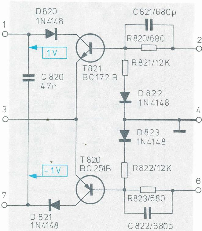
Fig. 31 Elektronische Sicherung IX
