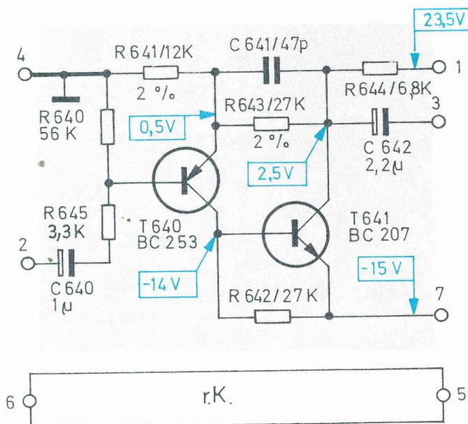
Fig. 27 Zwischenverstärker VII
