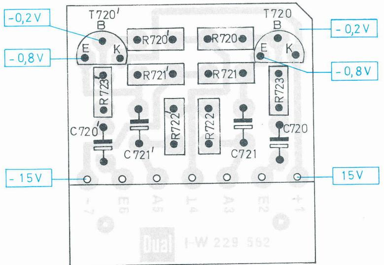
Fig. 26 Zwischenverstärker VII
