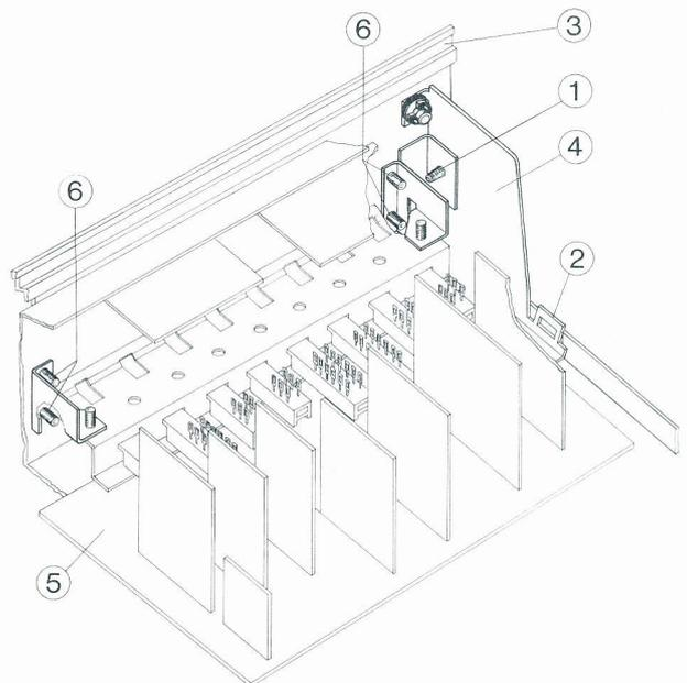
Fig. 6 Abgleichpositionen und Lageplan der Steckmodule
