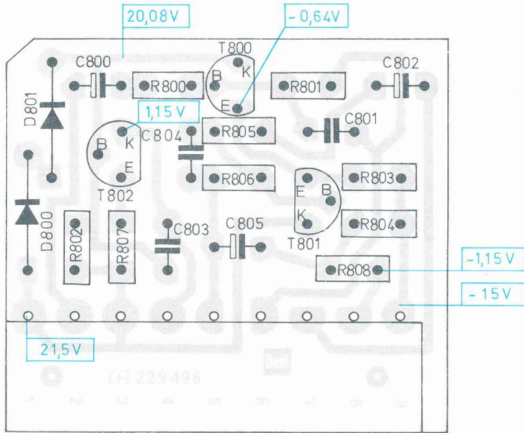
Fig. 30 Elektronische Sicherung IX
