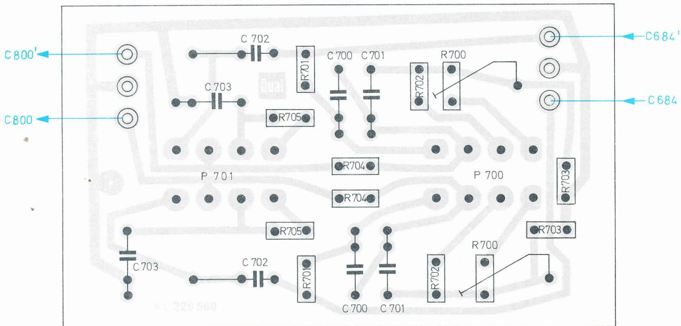
Fig. 12 Lautsprecheranschlußplatte 232 456 (Leiterseite)
