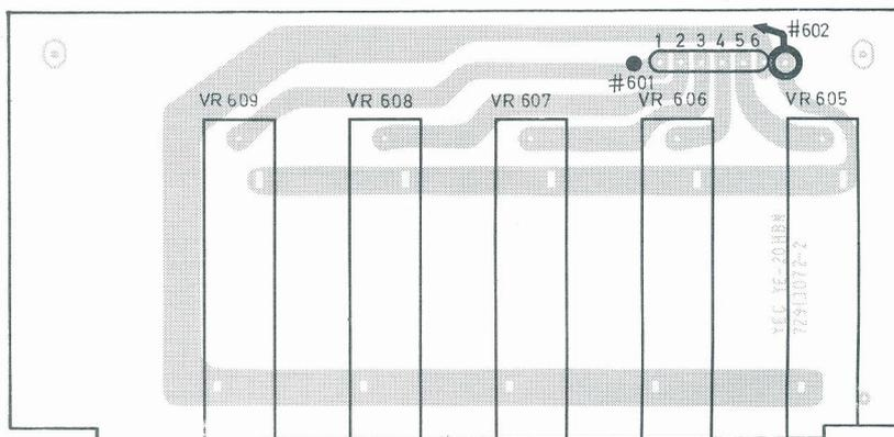
Tunerschalterplatte / Tuner switch PWB / Plaque de manoeuvre **B**
