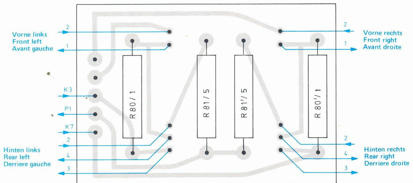
Fig. 8 Regelverstärker 230 606 (Leiterseite)
