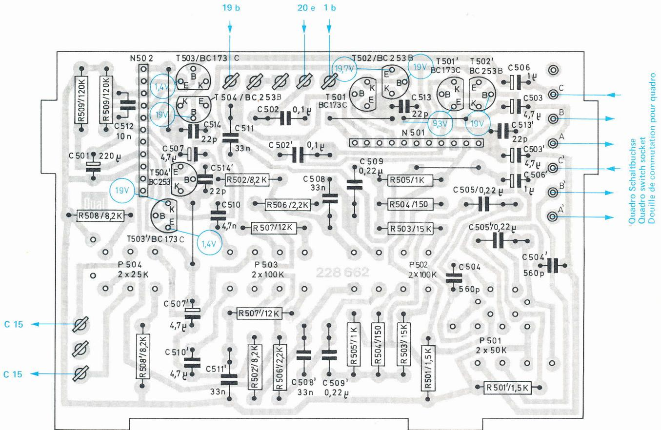
Fig. 9 Endverstärker 230 607 (Leiterseite)
