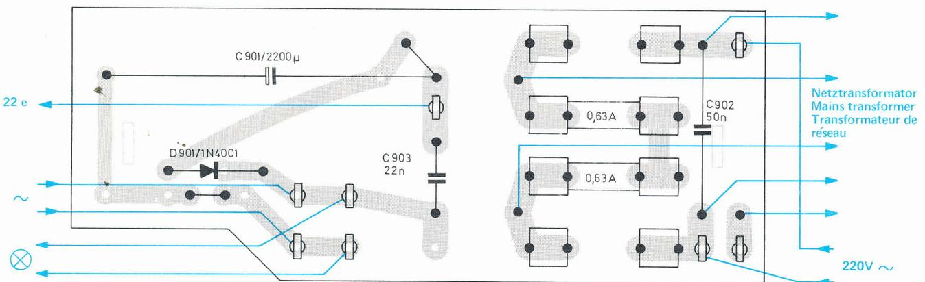
Fig. 12 AM-HF-Platte 231 206 (Leiterseite)
