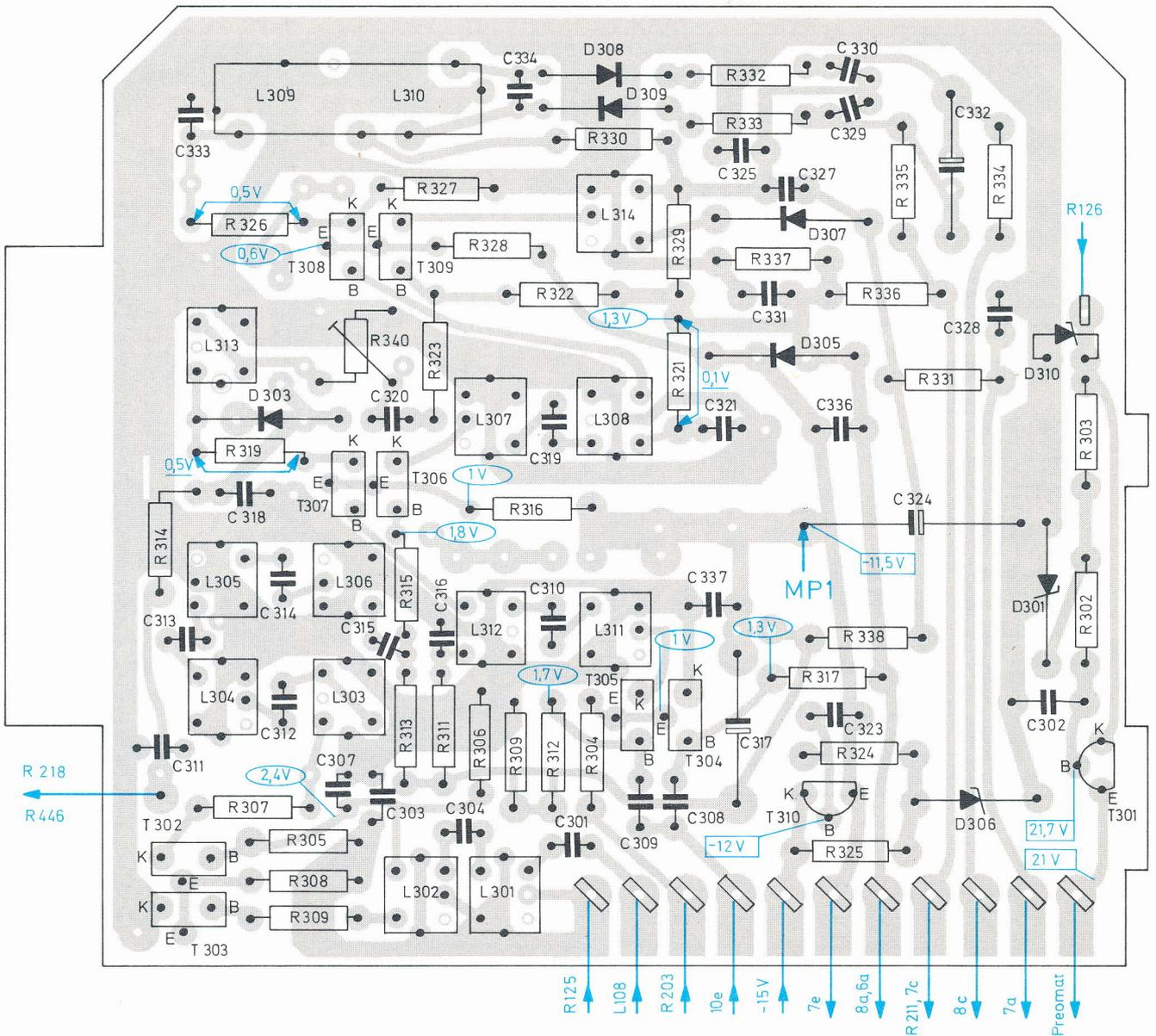
Fig. 5 Vorverstärker 227 746 (Leiterseite)
