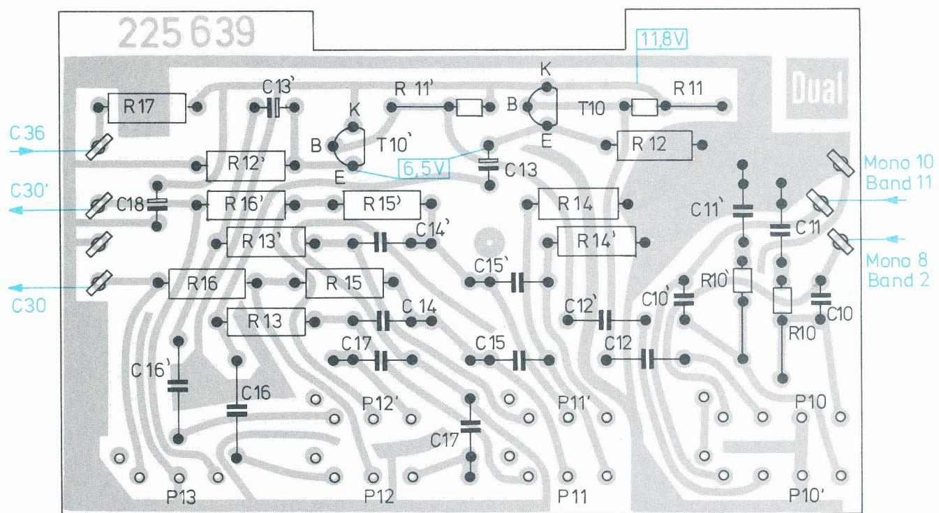
Fig. 8 Endverstärker 225 473 (Leiterseite)
