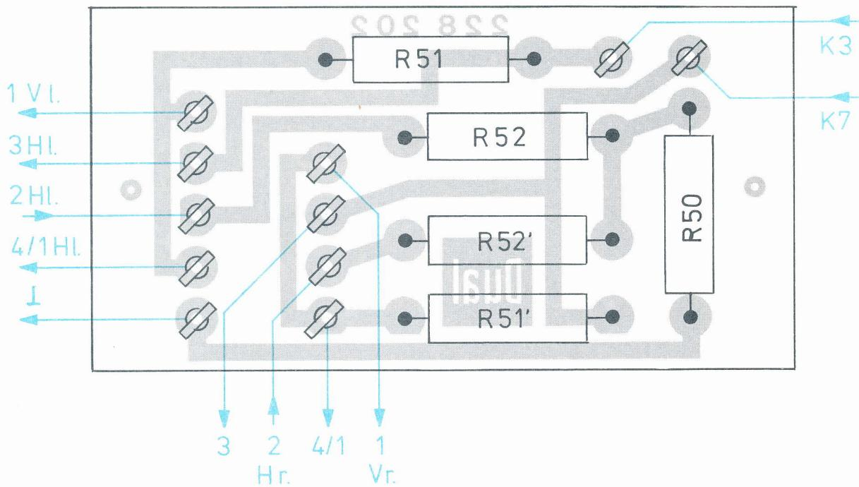
Fig. 10 Netzanschlußplatte 224 505 (Bestückungsseite)
